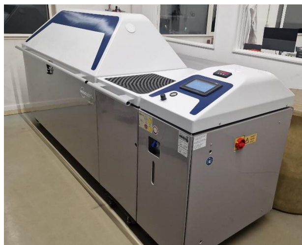
Figura 6 - Câmara de Nevoeiro Salino com Condicionamento Cíclico
